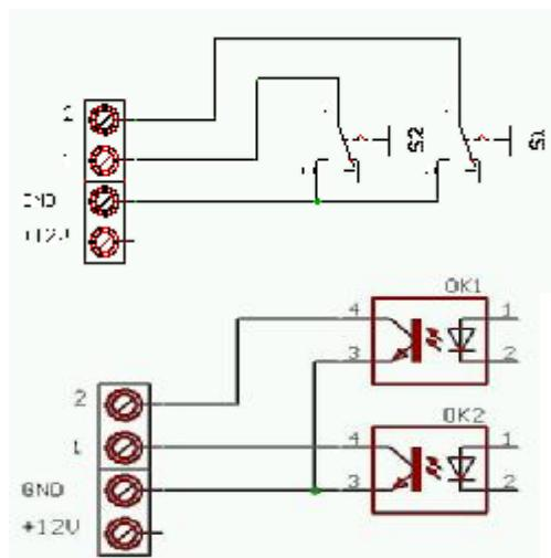
Zapojení s kontakty relé, spínači, kontakty magnetických spínačů apod.
