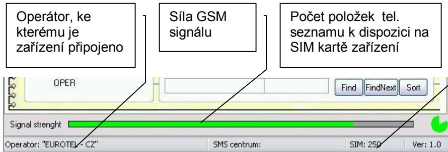
Program monitoruje komunikaci procesoru s GSM modulem v zařízení. Sdílí tuto komunikační cestu k modulu. Procesor s modulem pracuje v 30 sec. intervalech. Program má tedy periodicky vždy 30 sec. na vlastní komunikaci (načítání čísel a SMS do SIM zařízení. Tento čas znázorňuje kruhový graf v pravém spodním rohu programu. Mimo toto údobí (během práce procesoru s GSM modulem) jsou některé prvky zablokovány.
