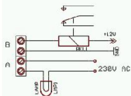
Připojení relé s vyšším výkonem (stykač), připojení žárovky (topení, motor čerpadla atd.).
