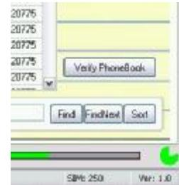
Seznam můžete také načíst ze SIM karty v zařízení, přidat ke stávajícím číslům na SIM kartě, nebo přepsat. Zápis na SIM je především u seznamů delších než 100 položek časově náročný (řádově minuty). Proto se při načítání či ukládání seznamu na SIM kartu v dolní části okna objeví „teploměr“ znázorňující průběh akce. Během této operace jsou ovládací prvky blokovány.
